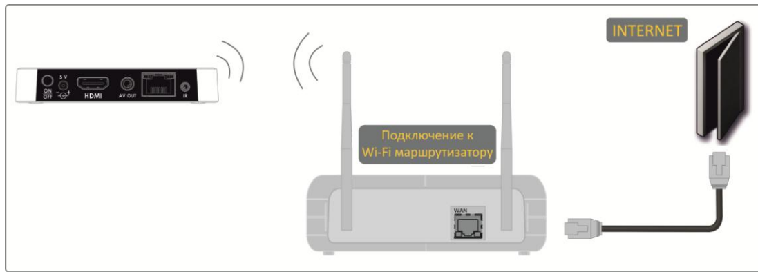
Рисунок 11 – Подключение к сети провайдера, используя Wi-Fi маршрутизатор
