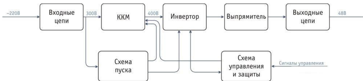
Рисунок 8 – Структурная схема модуля МП260
