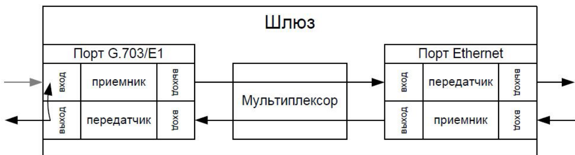
Схема прохождения сигнала в режиме удаленного шлейфа.
