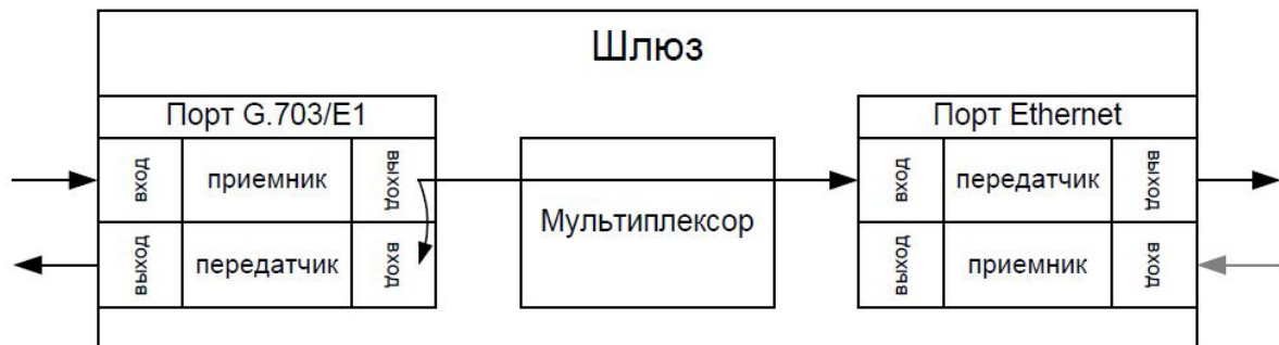
Схема прохождения сигнала в режиме удаленного шлейфа.
