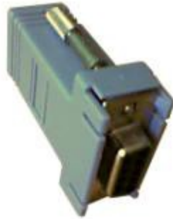
Внешний вид переходника RJ-45 - DB-9F
