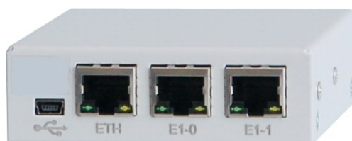
Рисунок 4 – Внешний вид мультиплексора TopGATE-2E1-1F
