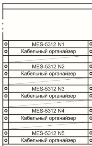
Рисунок 16 – Размещение коммутаторов MES5312 в стойке
