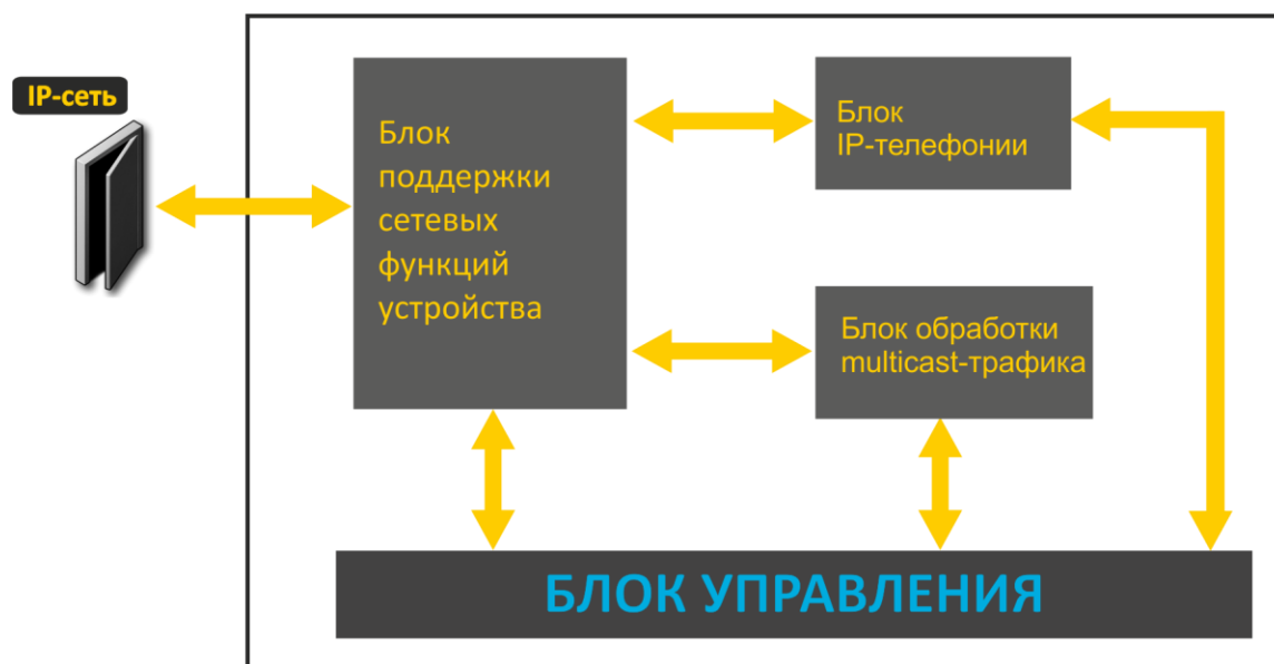
Рисунок 3 – Функциональная схема устройства серии TAU-4M.IP
