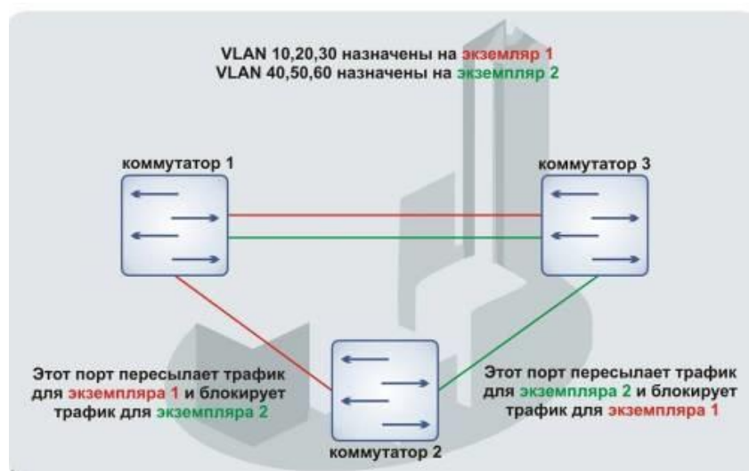
Рисунок А.1 – Настройка протокола множества связующих деревьев
