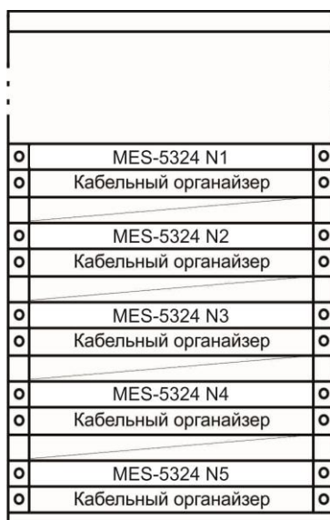
Рисунок 40 – Размещение коммутаторов MES5324 в стойке
