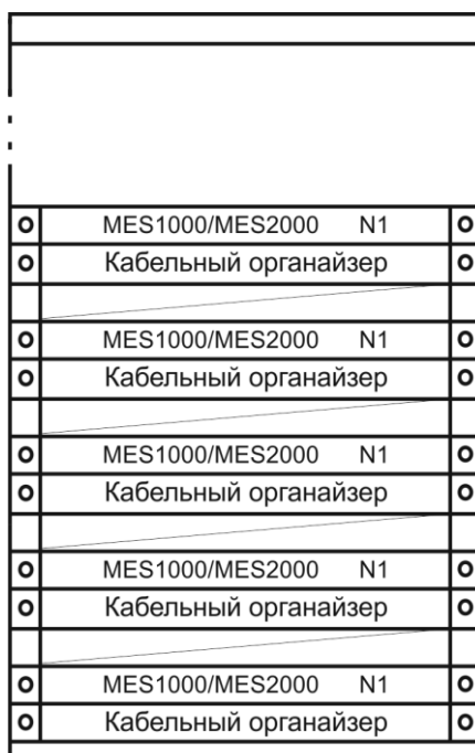
Рисунок 23 – Размещение коммутаторов в стойке
