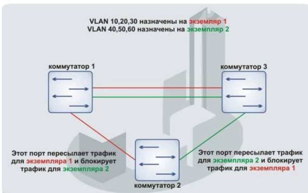
Рисунок 31- Настройка протокола множества связующих деревьев
