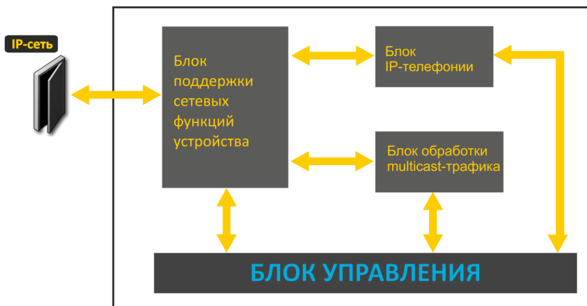
Рисунок 3 – Функциональная схема устройства серии TAU-1M.IP
