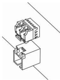
Рисунок 44 – Установленные SFP-трансиверы
