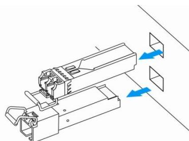
Рисунок 46 – Извлечение SFP-трансиверов
