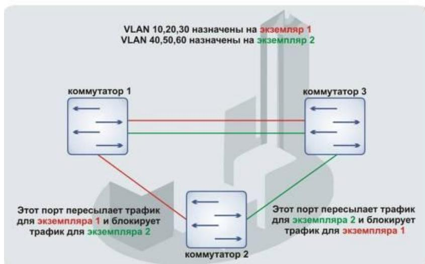
Рисунок А.1 – Настройка протокола множества связующих деревьев
