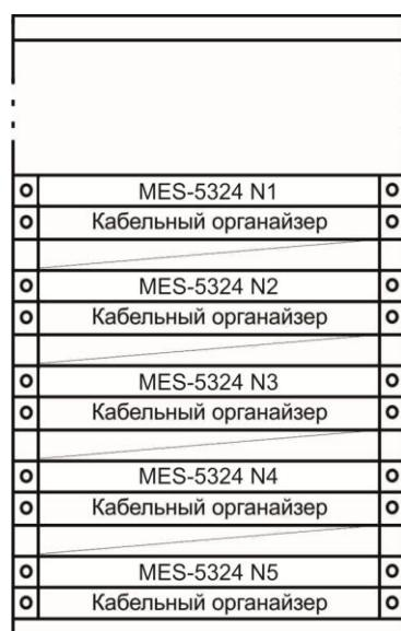
Рисунок 40 – Размещение коммутаторов MES5324 в стойке
