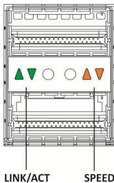
Рисунок 35 – Внешний вид разъема с QSFP-трансиверами
