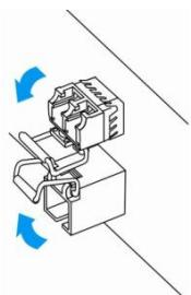
Рисунок 45 – Открытие защелки SFP-трансиверов
