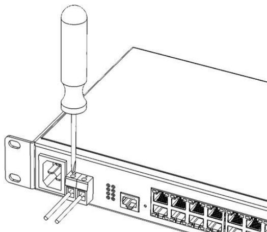
Рисунок 42 – Подключение АКБ к устройству
