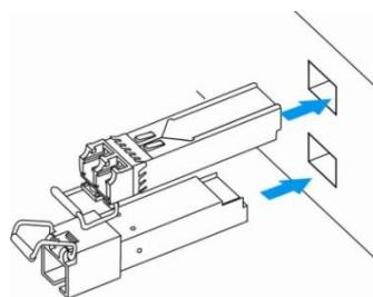
Рисунок 43 – Установка SFP-трансиверов
