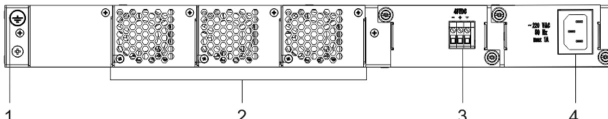
Рисунок 26 – Задняя панель MES3316F
