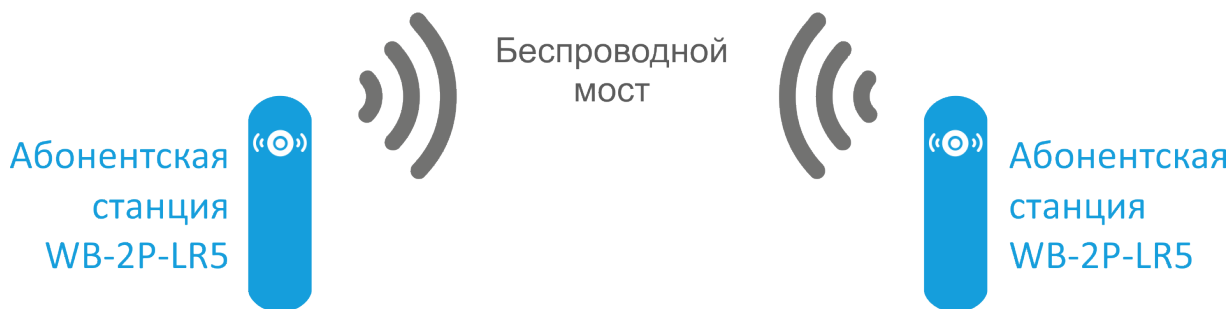
Функциональная схема использования WB-2P-LR5 для организации беспроводного моста
