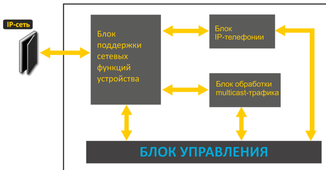
Рисунок 3 – Функциональная схема устройства серии RG-2400/RG-4400
