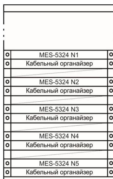
Рисунок 40 – Размещение коммутаторов MES5324 в стойке
